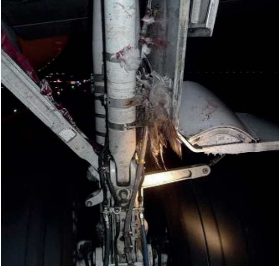
Afbeelding 3: vogelresten gevonden in het linkerhoofdlandingsgestel na de landing
