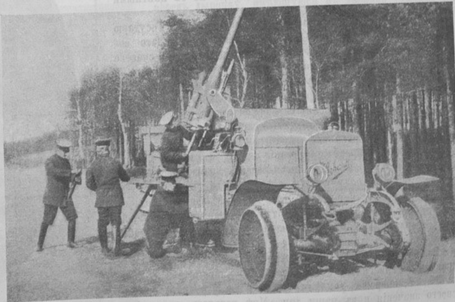
7,5 сант. пушка Эрхардта на блиндированномъ автомобилѣ, для обстрѣливанія воздухоплавательныхъ аппаратовъ. (Къ ст. „День воздушнаго флота“).
