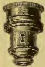
Fig. 19. Achromatisches Linsensystem mit Korrekptionsapparat.
