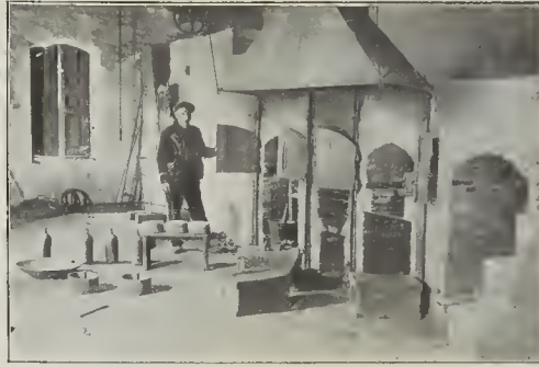
Hornos de destilación y fundición. Delante del horno se ven los panes de plata y sus moldes
