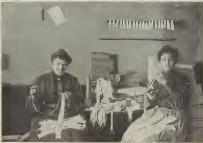
Fig. 1. - Operación de cortar el tejido tubular y de colocar los alambres de amianto
