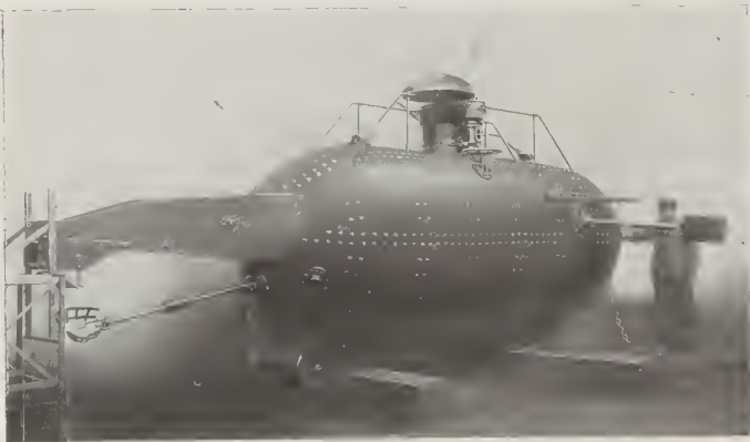
Fig. 1.—Submarino para la pesca de esponjas en la costa de Túnez
