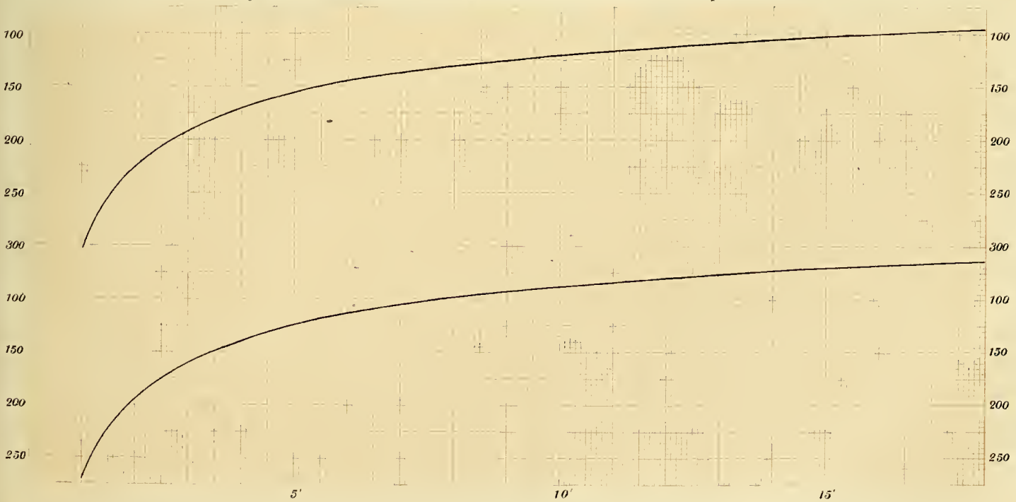
Fig. 10. 11 - Corrente di carica e scarica per un cond. a carta paraffinata
