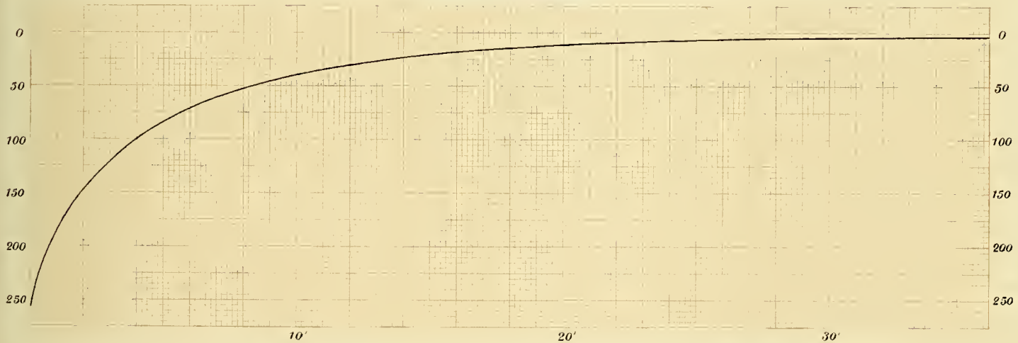
Fig. 10. 11 - Corrente di carica e scarica per un cond. a carta paraffinata
