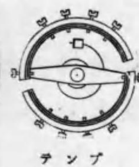
図 懐中時計が遅れる時、調整用の針をFの方へ寄せるのは何故か。
