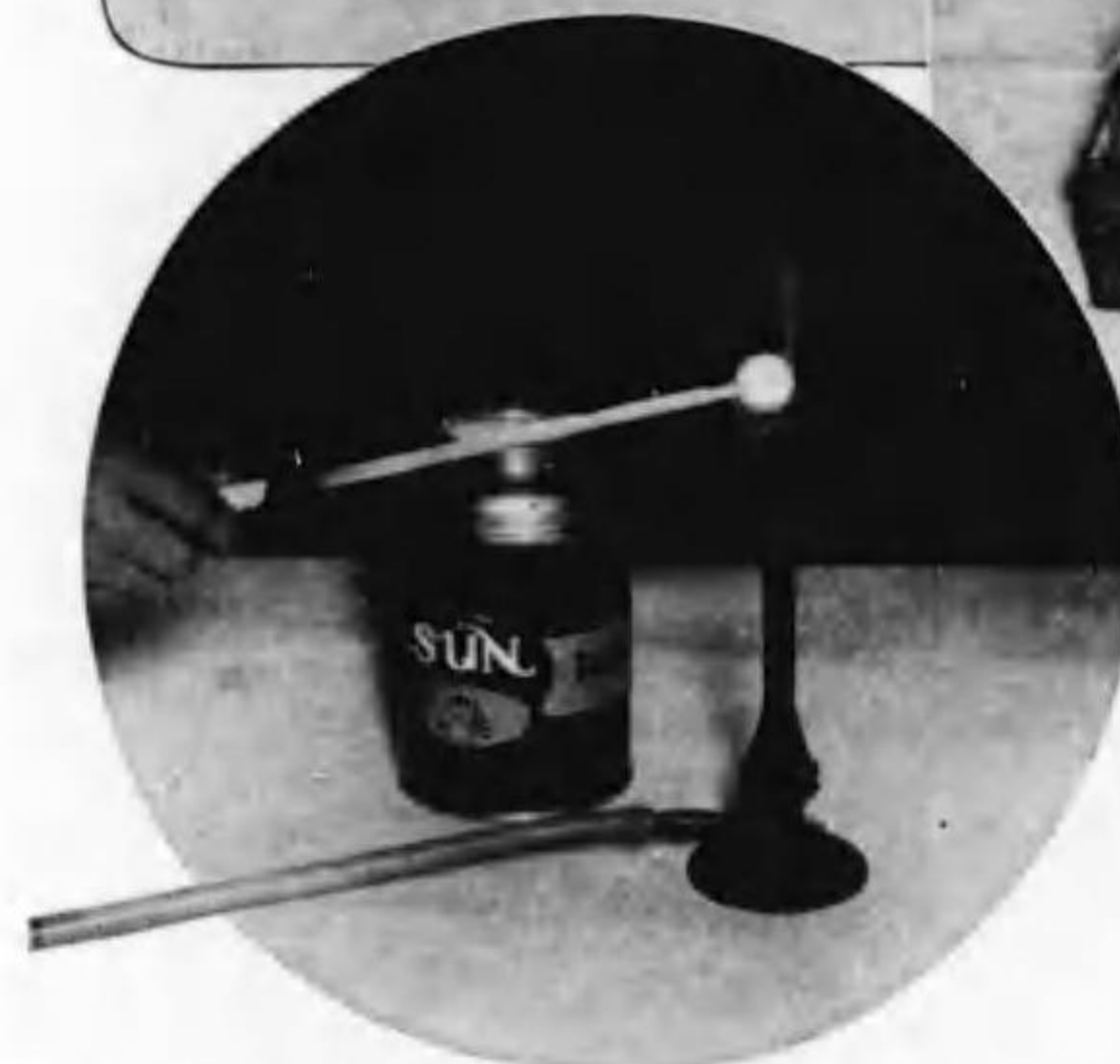
↑ 液體空氣に冷やした金屬球をガスの 焰の中に入れると表面に雪を生ずる
