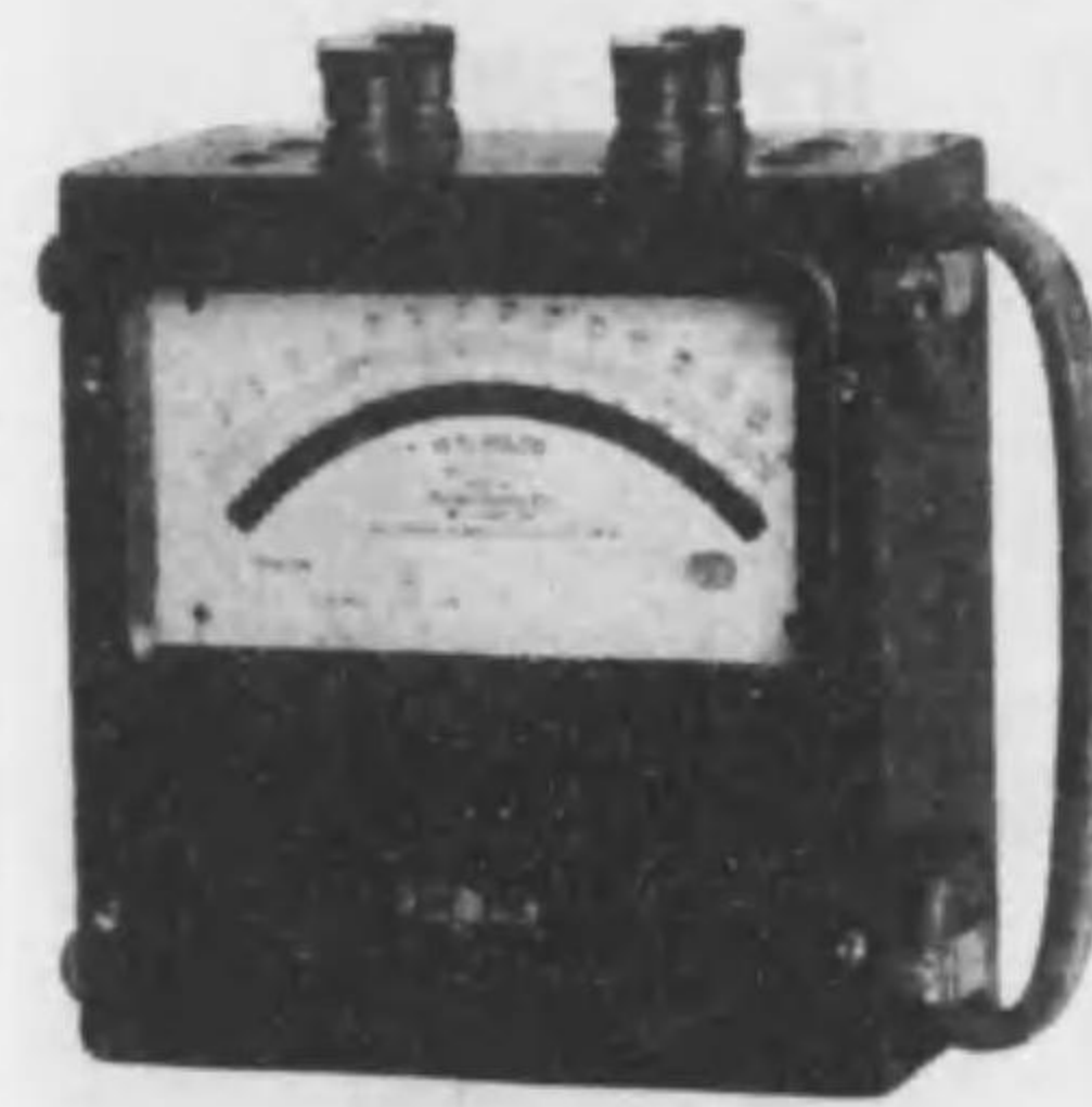
ローラーズミス GS型 携帯用標準電圧計
