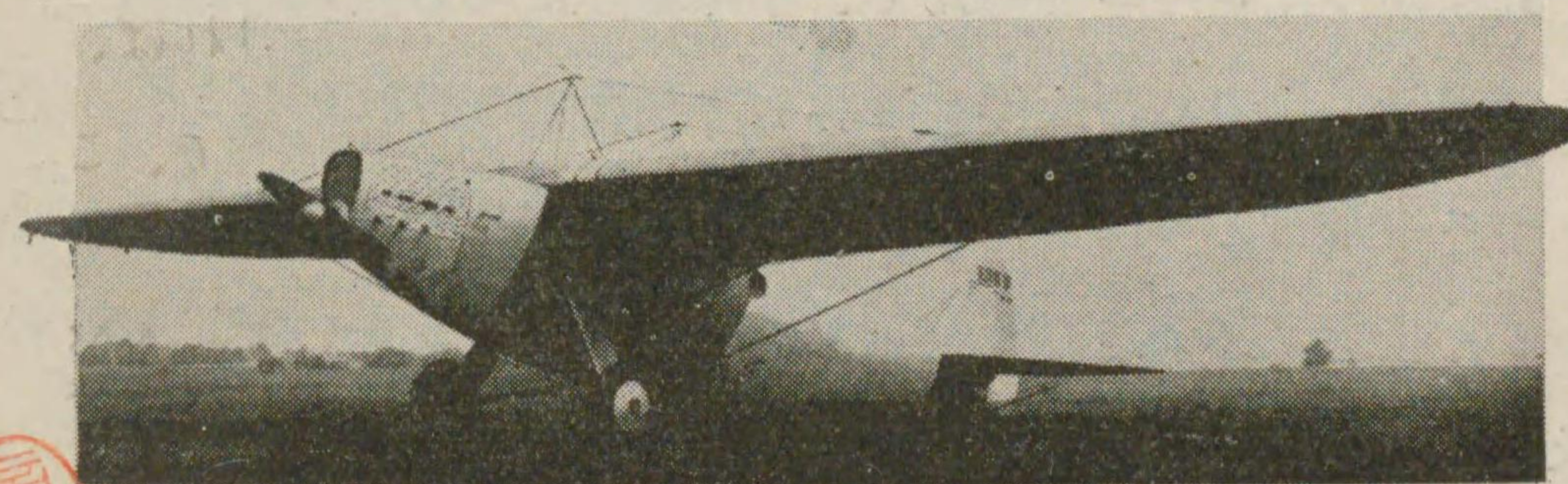
全備重量 8,600 kg, 燃料搭載量 5,700 kg, 最大速度 220 km/時。
