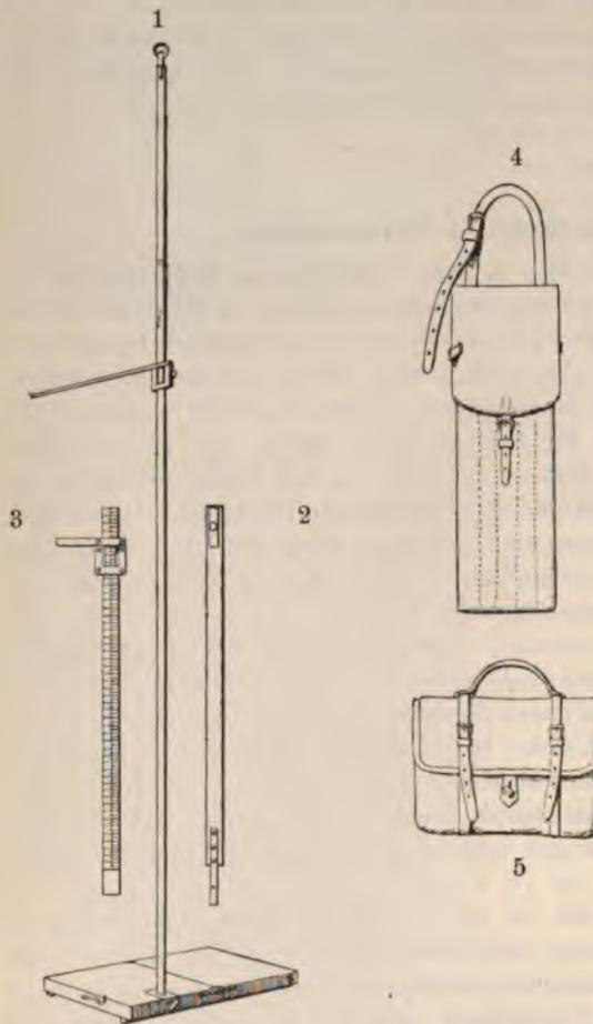
in den Erdboden eingestossen werden; für gewöhnlich wird derselbe bis zu dem Anfangsstrich der Skala in einen mit Metallplatten ausgefüllten Schlitz des Fussbrettes eingelassen und durch eine Schraube festgestellt. In diesem Zustande erhält sich die Stange, wenngleich in etwas schwankender Bewegung, freistehend. Die zu messende Person tritt auf das Fussbrett, mit dem Rücken gegen die Skala gerichtet.
