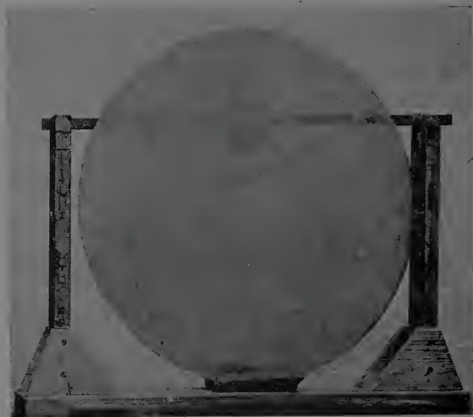
Fig. 72. — La lentille de crown de 1 m ,05 de diamètre après le dernier moulage.
