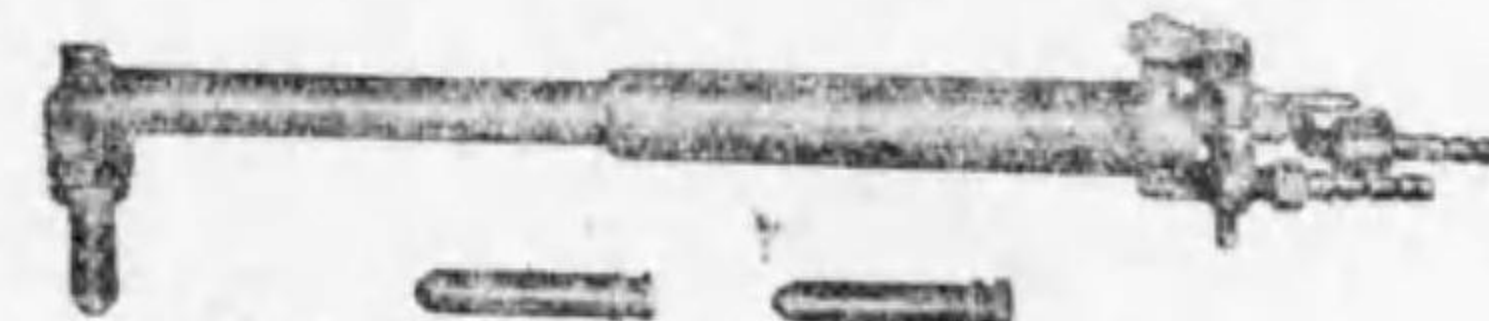
第621圖 ピロコップ式鑄鐵切斷用吹管
