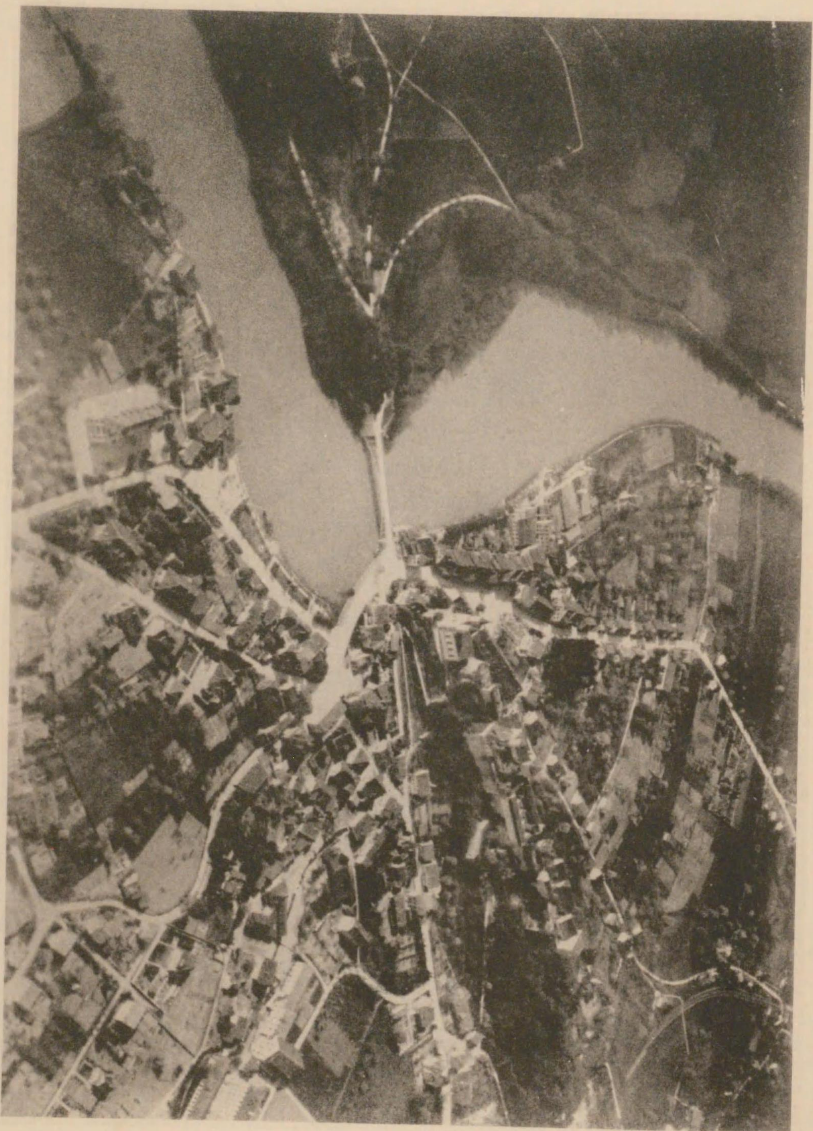
河の一方に發達した都會 (Aarburg, Schweiz) 「橋本村」の典型的のものである。橋は河の狹隘地を占めてゐる。橋の据を中心として放射状に 街路が走つてゐる。町の生命は橋の一點に集中されてゐる。對岸は殆んど利用されてゐない。
