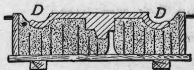
第一百三十九圖 作成上型之分型面
