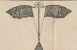
1872. — HUREAU de VILLENEUVE. — Oiseau mécanique dont l'axe de rotation est incliné à 45°. Cet appareil, expérimenté devant la Société Française de Navigation aérienne, a volé avec une vitesse de 9 mètres par seconde.
