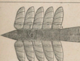
1864. — STRUVE et TELESCHOFF. — Ailes mues par la force humaine agissant sur un ressort.
