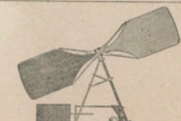
1871. — POMÈS et de la PAUZE. — Appareil pourvu d'un gouvernail et d'une hélice actionnée par un moteur à poudre.
