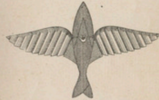
1857. — LE BRIS. — L'auteur prévoyait l'abaissement des ailes à l'aide de leviers; des ressorts aidaient à les relever.
