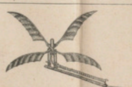
1872. — JOBERT. — Oiseau mécanique à quatre ailes, dont le battement, au rythme du trot, produit l'équilibre de l'appareil.
