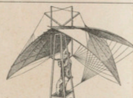
1864. — De GROOF. — Appareil composé d'ailes mues par trois leviers, et dans lequel l'auteur trouva la mort.
