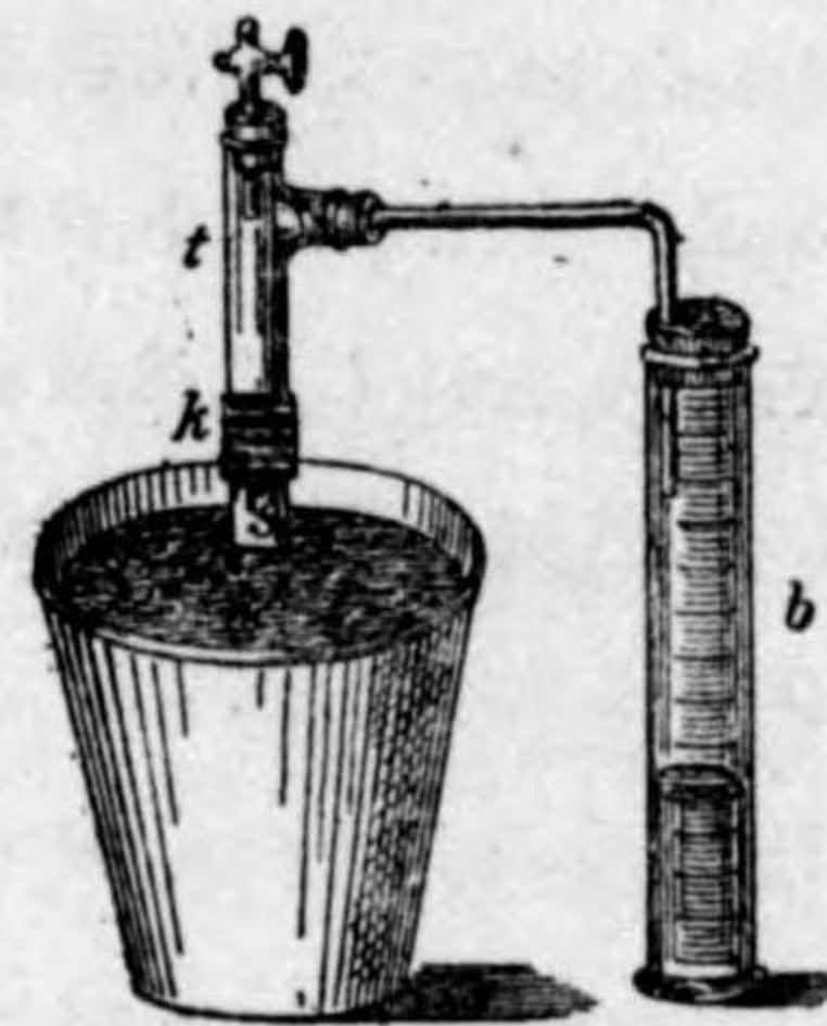
s、實驗植物の莖 k、護膜管 T、T字形管 C、刻度硝子器
