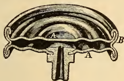
FIG. 21. Utica Capsular Spring.
