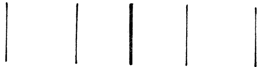
第二十三圖 用繞射光柵所得單色光之繞射。
