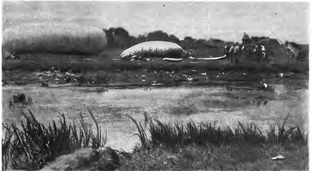
Наполненіе газами управляемаго аэростата.
