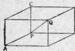
P 及ビ Q ヲ通り各座標平面ニ平行ナル平面ヲ引イテ直六面體ヲ作り, PA, PB, PC ハ夫々 x 軸, y 軸, z 軸ニ平行ナル稜デアルトスレバ, PQ ノ方向餘弦ハ  $\frac{PA}{PQ}, \frac{PB}{PQ}, \frac{PC}{PQ}$  デアルカラ
