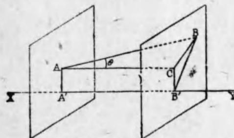
有向線分  $AB$  ノ兩端  $A, B$  ヲ通り、直線  $XY$  ト直交スル二ツノ平面ヲ作り、ソノ交點ヲ  $A', B'$  トスレバ有向線分  $A'B'$  ヲ直線  $XY$  ニ投ジタ有向線分  $AB$  ノ射影 (Projection) ト云フ。
