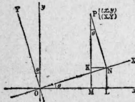
$Ox, Oy$  ヲ舊軸、 $OX, OY$  ヲ新軸トシ、舊座標ヲ  $(x, y)$ 、新座標ヲ  $(X, Y)$  トスル。
