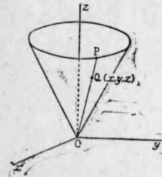
導線ガ圓ナル錐面ヲ圓錐面ト云ヒ、此ノ圓ノ中心ト頂點トヲ結ブ直線ガ此ノ圓ノ平面ニ垂直ナルモノヲ直圓錐面ト云フ。
