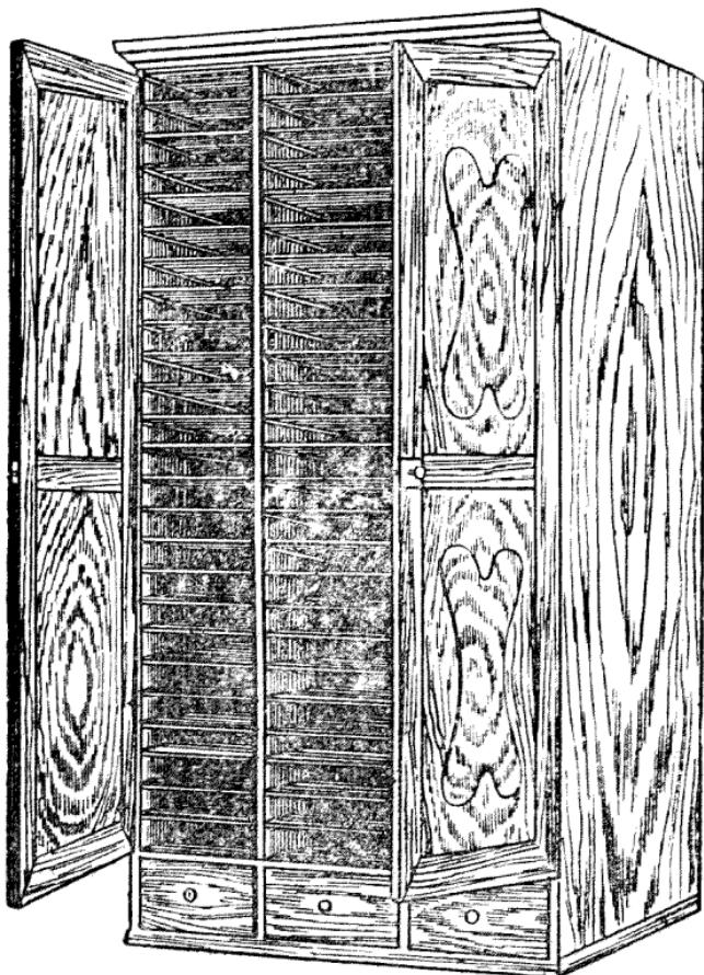
箱普通用櫟木製造，有二扇門，內部分成許多的層，各層的板可自由抽出和安放。箱高五尺四五寸，寬三尺五六寸，深一尺八九寸，夾層的板寬一尺一寸五分，
