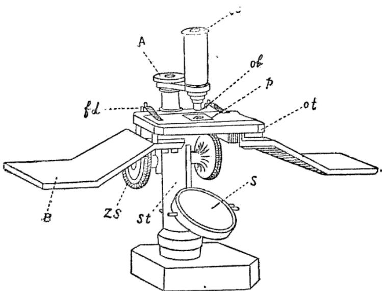
oc 接目鏡 ot 載物台 A. 支腕器 ob 接物鏡 fd 壓條 B. 革被
