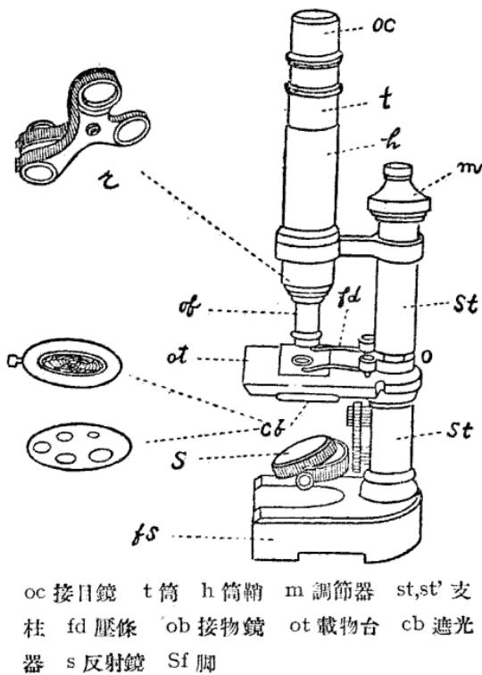
布去擦就要把鏡片擦壞的。如管筒在管鞘中向上下移動不甚圓滑時可塗些石蠟油在筒面及筒鞘內，殘餘的油要用乾棉布拭淨。又在使用後，不免沾染手指上的油脂，所以必須用絨布仔細拭淨。調節器不可旋得太厲害，以免螺旋受損。在握持顯微鏡時，切不可握住鏡筒，要握在支柱的地方。
