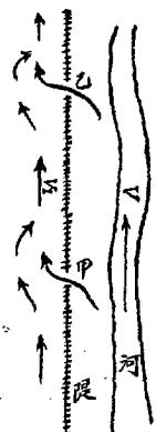
至濾水由水門注入隄後，何以能使之濾濁，則可以下圖明其理：水自甲水門注入隄後，其流速V，必較緩於正河之流速V<sub>1</sub>，即V<sub>1</sub> > V。故甲門之水流至乙門時，正河之水亦已自乙門注入。堤後之水為其所托，其勢更緩，且更向後漫旋。其所挾之泥沙，勢必無力攜帶，而盡捨於是，愈積愈高矣。此後世所放淤之理所從出也。
