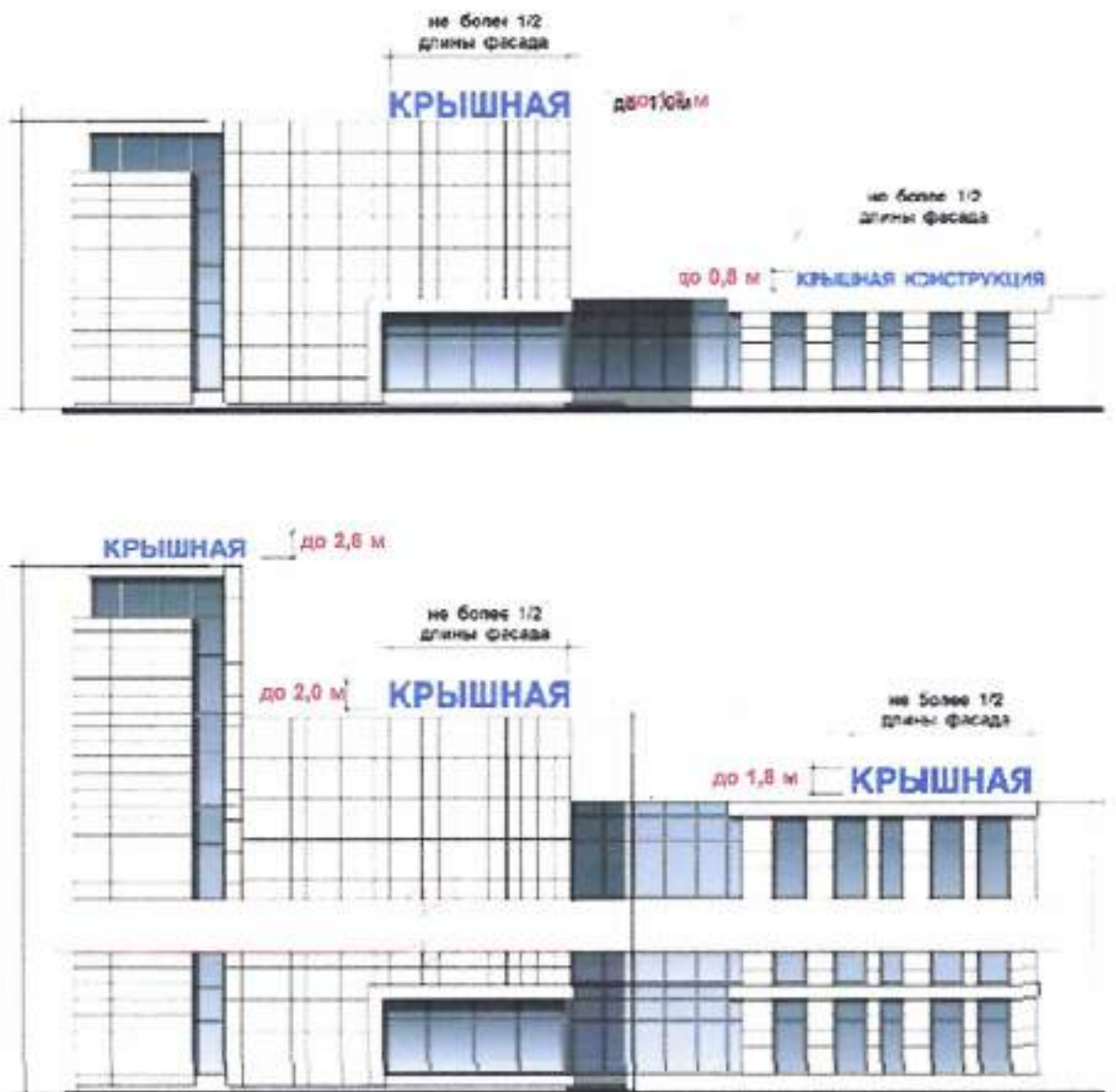
Рис. 43 Примеры и принципы размещения крышных конструкций
