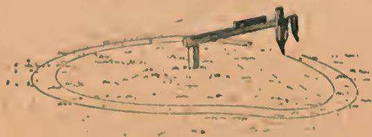
Fig. 1. O traçado da valleta para fazer a boca. Quando o terreno não é plano, prolonga-se os marcadores seguindo o terreno maior com um delles como mostra o chche, subulora ou baixando a para que toque o solo, porem o poleão deve conservar se sempre em nivel.
