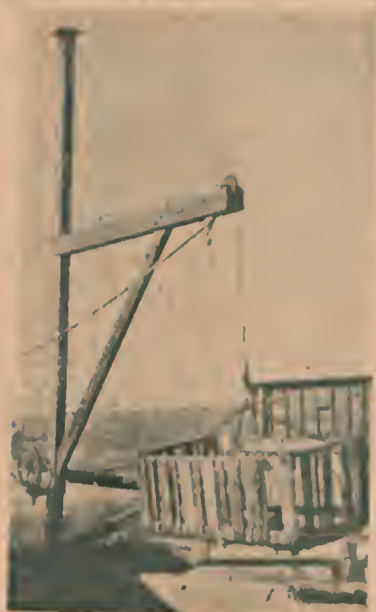
Fig. 4 — Um guindaste de madeira muito simples, feito à mão, para a extração da ensilagem dos silos subterrâneos.
