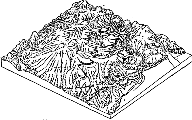
第一五九圖 兼用等高線法及暈滃法的斷塊圖
