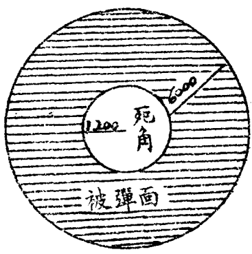
高射砲射擊四千米突高度其有效被彈面之截面圖
