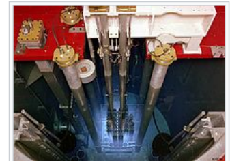
Het hart van een onderzoeksreactor voor kernsplijting: splijt- en regelstaven
