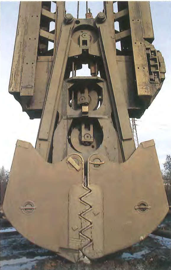
Figures 98 et 99 : la réalisation des parois moulées du tunnel de Kinkempois – À gauche, le grappin, utilisé pour l'excavation entre les murets-guides ; à droite, la mise en place, après excavation et avant bétonnage, des cages d'armature (décembre 1997) © Daylight et V. Remy
