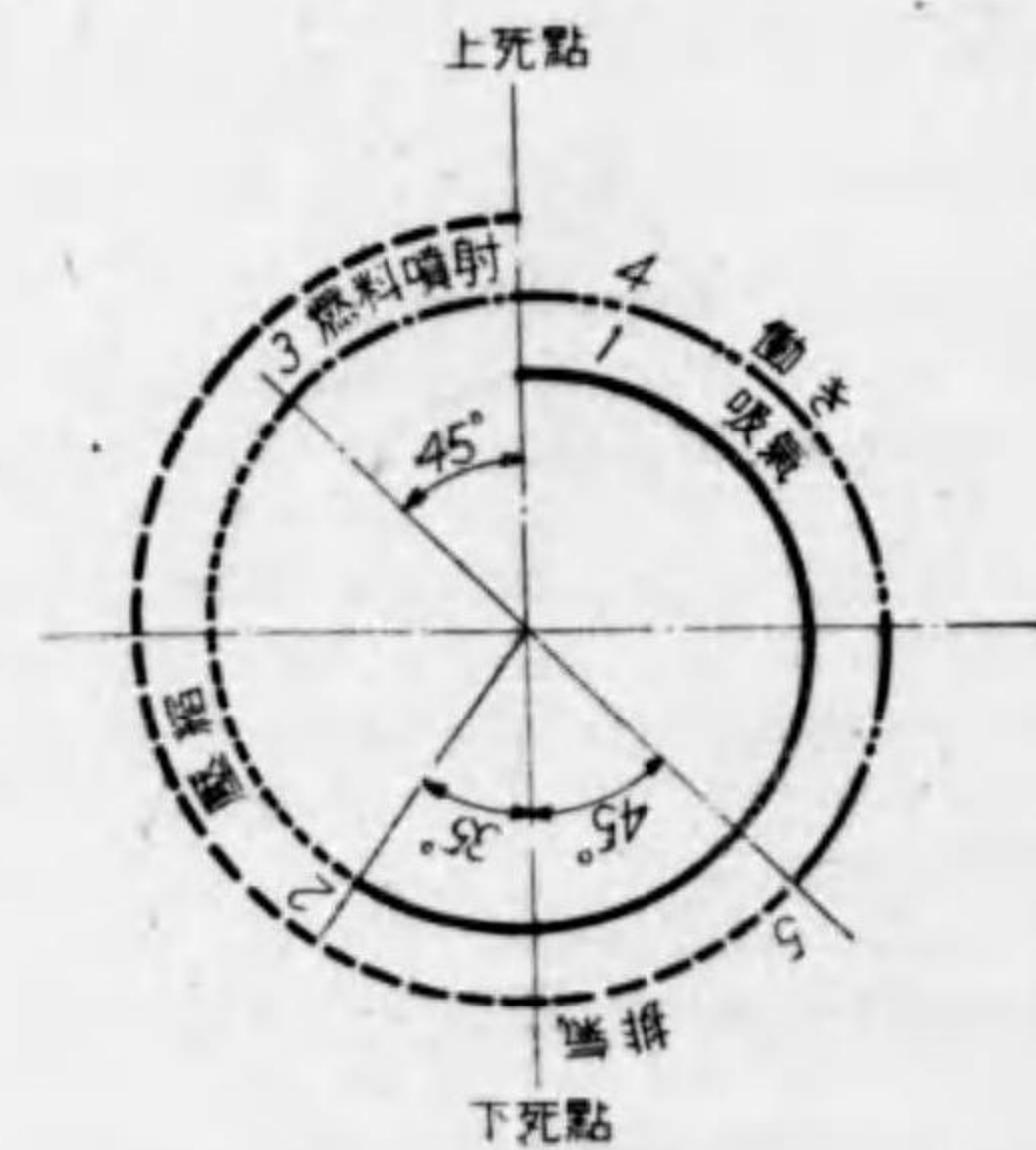
第 134 圖 Packard 機関弁線圖
