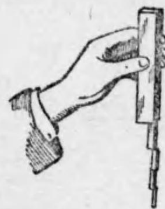
磁氣誘導の作用で小鐵片が順次磁石になる
