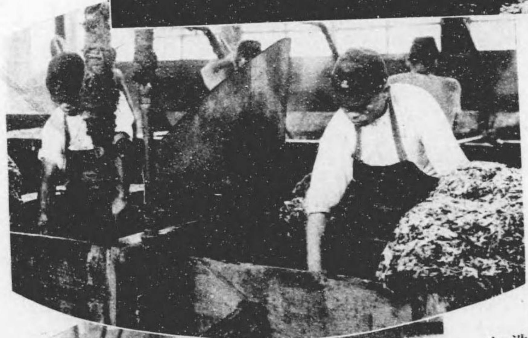
比須の除水(3) 洗滌した比須は直ちに遠心分離機にかけて除水 する。壓搾器に依る除水は絶對に避けませう。
