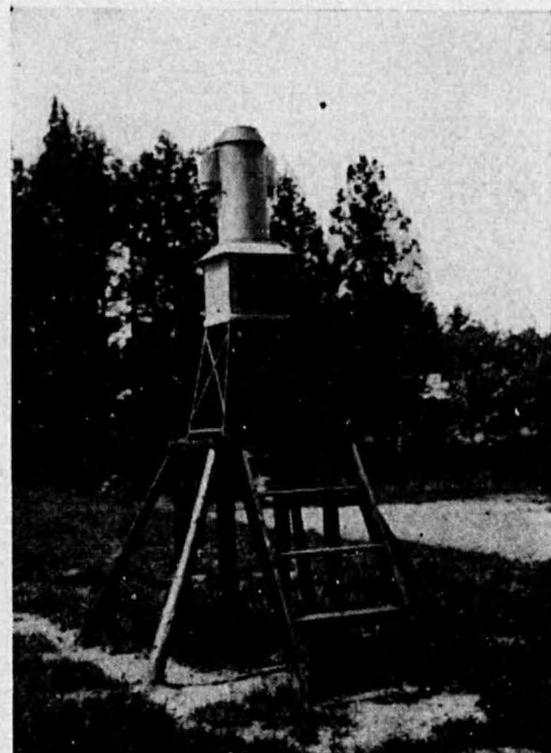
中央氣象臺自記雪量計 臺の高さ四尺四寸 昭和三年六月撮影
