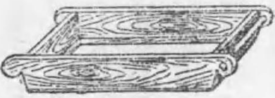
第七圖 石灰・砂煉瓦の大きさは普通縦二五〇耗、横一二〇耗、厚さ六五耗である。これ等の煉瓦は或は特殊な枠を用ひて手工的方法で或はまた手押壓搾器を用ひて製造される。手工的方法による場合は木製又は金屬製の枠が用ひられる。(第七圖参照)
