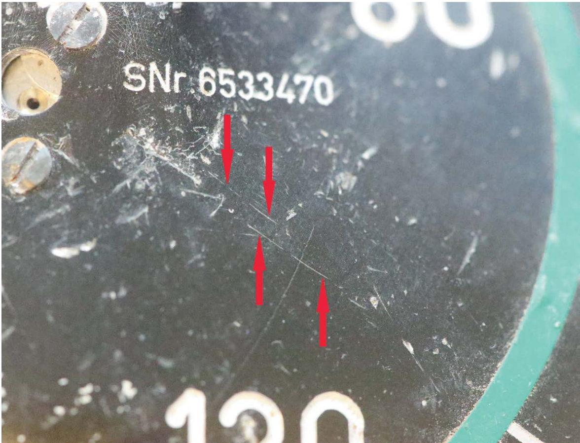
Figuur 7: Detailfoto van de snelheidsmeter met indruk van de aanwijspaal. (Foto: Onderzoeksraad voor Veiligheid)
