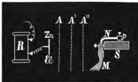
Рис. 15. R—бобина; ZnEl—электродъ; NM—лагушечій препаратъ прикрѣпленъ къ толстой парафиновой пластинѣ S помощью двухъ булавокъ.
