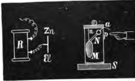
Рис. 16. R—бобина; ZnEl—электродъ; NM внутри стекляной баночки, подвѣшенъ на ниткѣ p ; a —наружный конецъ нитки, привязанной къ позвоночнику p ; S—парафинъ.
