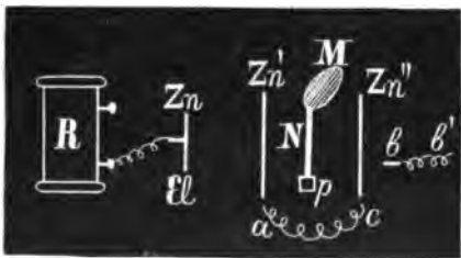
Рис. 21. R—бобина; ZnEl—электродъ; Zn' и Zn'' —металлическія пластинки, между которыми помѣщенъ препаратъ NM; ac—проволока для соединенія Zn съ Zn'' ; bb' —проволока отъ земли.
