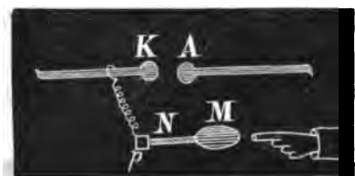
Рис. 11. КА—концы разрядника электрической машины; рNM—лягушечій препаратъ.
