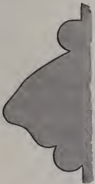
BAND TO NA VE PIER S. PERPENDICULAR.
