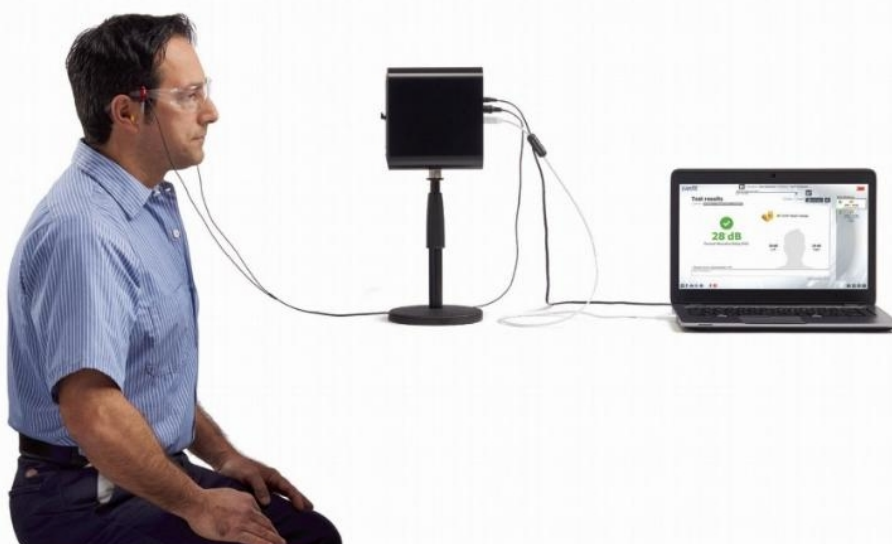
Фиг. 1. Использование системы производственного контроля эффективности СИЗОС (E-A-Rfit™). Участник сидит на расстоянии около 30 см от динамика, подключенного к компьютеру, на котором установлено программное обеспечение системы. Он вставил в слуховые каналы вкладыши с пробоотборными зондами, присоединёнными к микрофонам, закреплённым на дужках очков.
