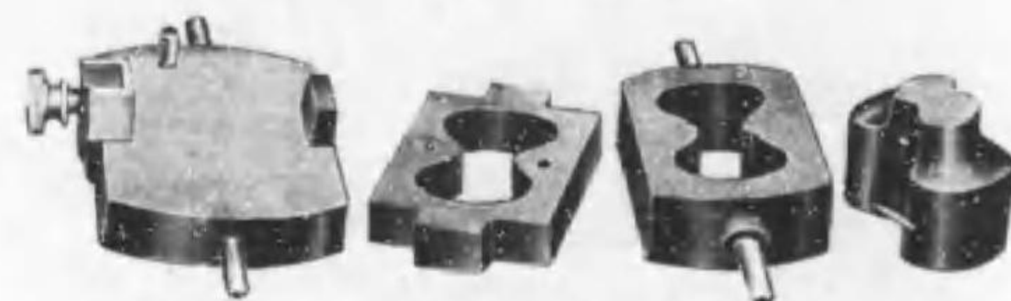
模型臺 抗張模型 添型 鐵 鉛 Plate. Tensile mould. Guide. Push Iron.
