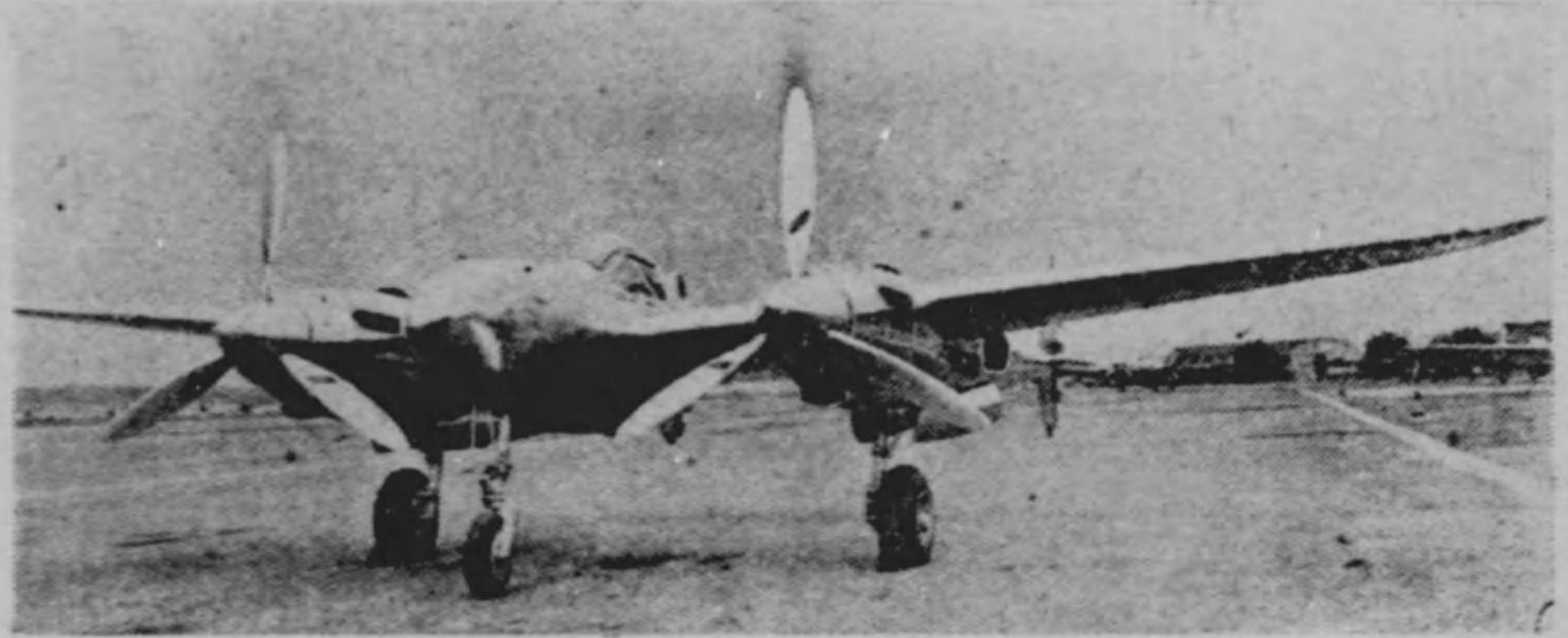
ロッキードP38単座戦闘機(アメリカ) 幅15.85米、長さ11.53米、 高さ3米、發動機2基計2180馬力、機銃4、最大650軒時。
