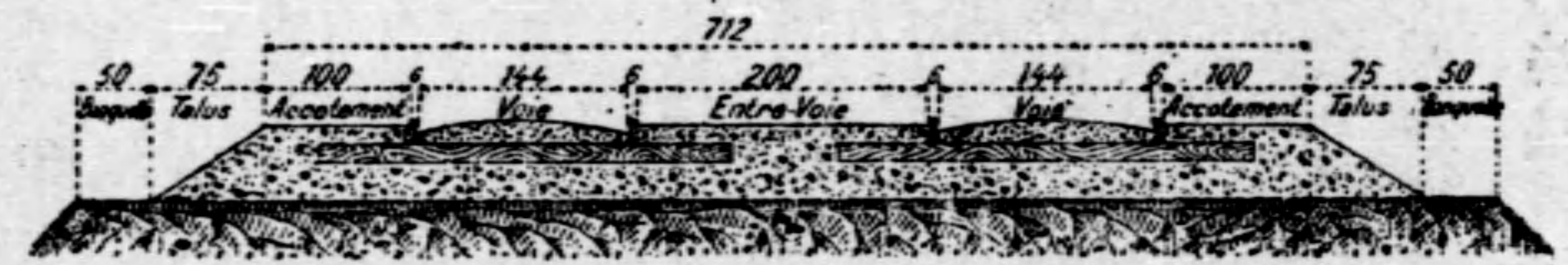
Fig. 40. — Profil d'une ligne à double voie normale
