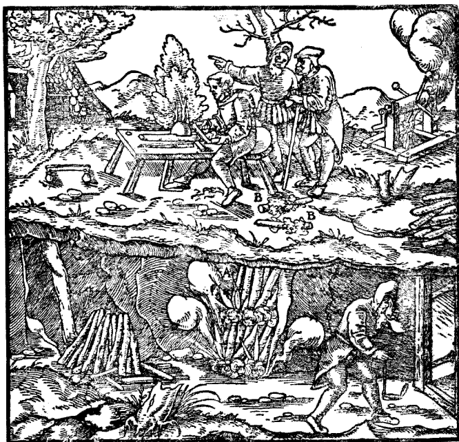
圖五十五——更迭地用水和火來分裂岩石。圖中上面的礦工正在做一束一束的柴把，下面的礦工則正將火燃着而後趕快地離開。
