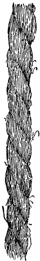
圖三十三 單紗纖維的撚回。和兩根單紗併合起來的撚度的中間是維持着這樣的一個關係，就是使纖維和後者的軸線處於互相平行的地位。
