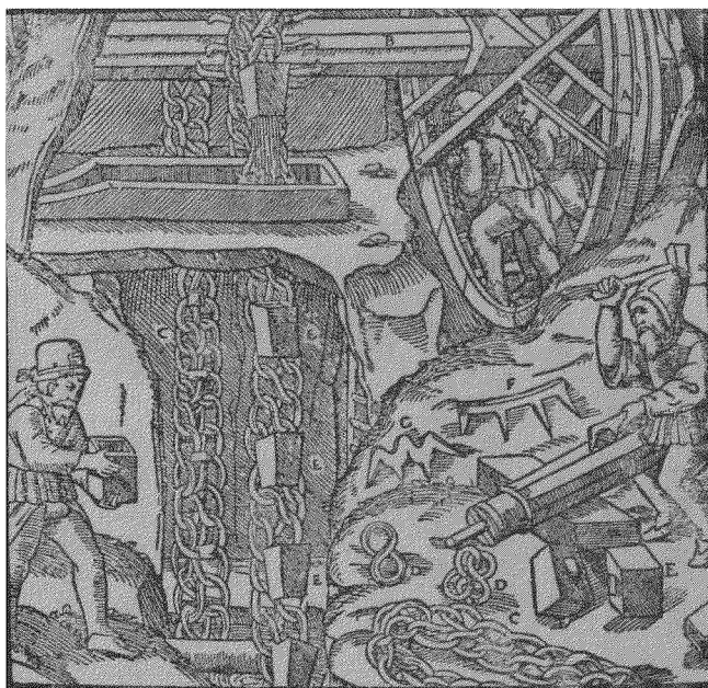
圖四十四——用踏車發動的鍊條戽斗排水圖 圖中一個人正在端着新的戽斗，一個人正在將夾鉗（如 F 及 G）嵌入一個捲筒（如 B）裏。
