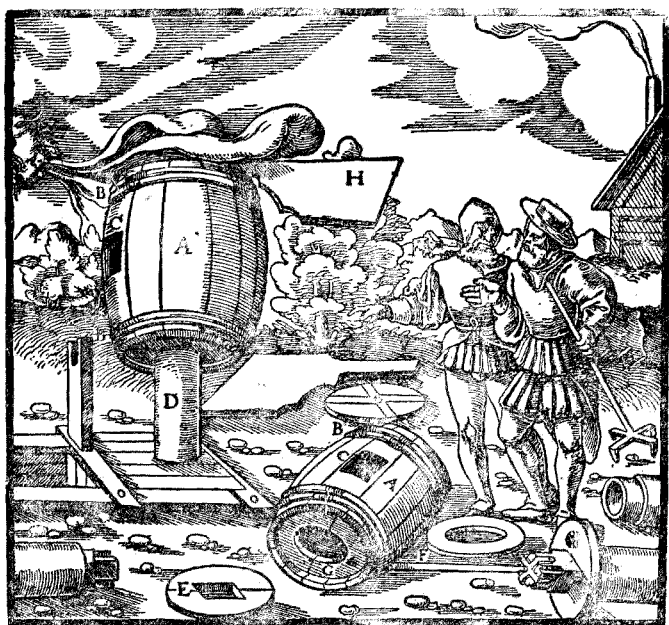
圖五十三——阿基柯拉書中所示的通風器。圖中自左邊吹來的風我們可以見到。
