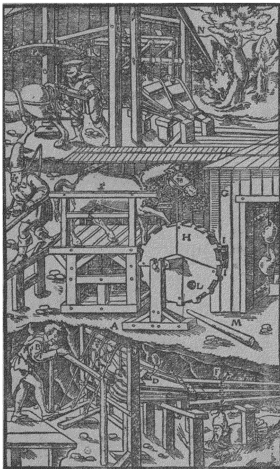
圖五十四——各種導風入礦的方法
