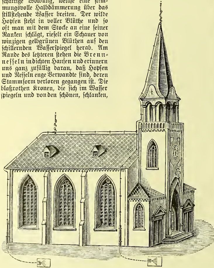
Fig. 1. Kirche mit Blitzableitern und zwei Erdplatten.
