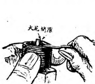
第三十九圖 火星塞間隙校準法
