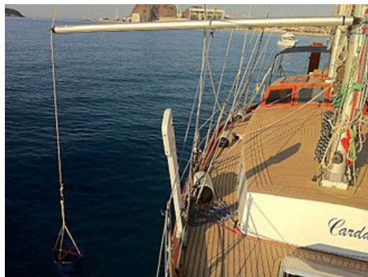
La drisse est débordée pour augmenter l'amortissement
