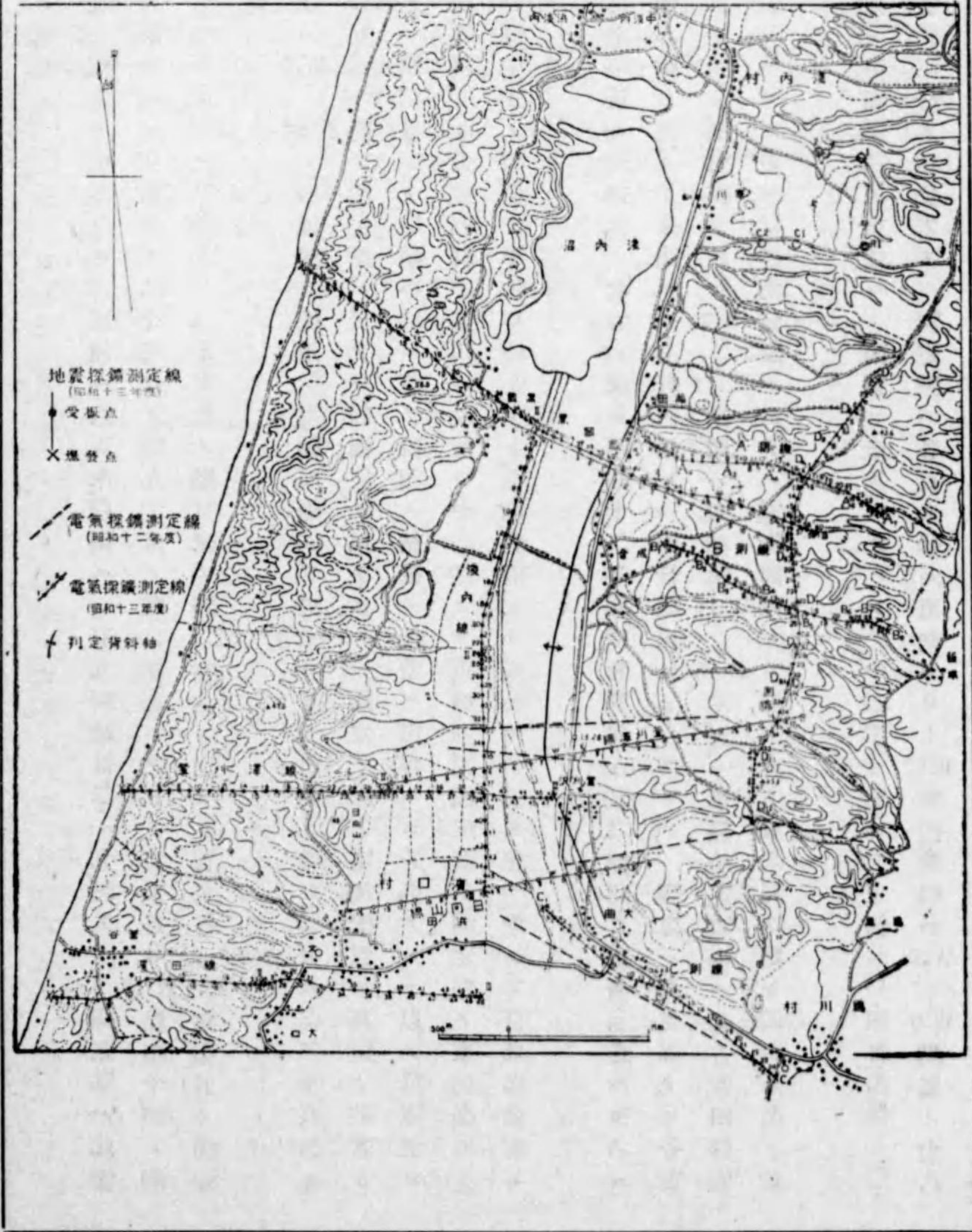
第一圖 能代油田物理探鑛測定線配置圖
