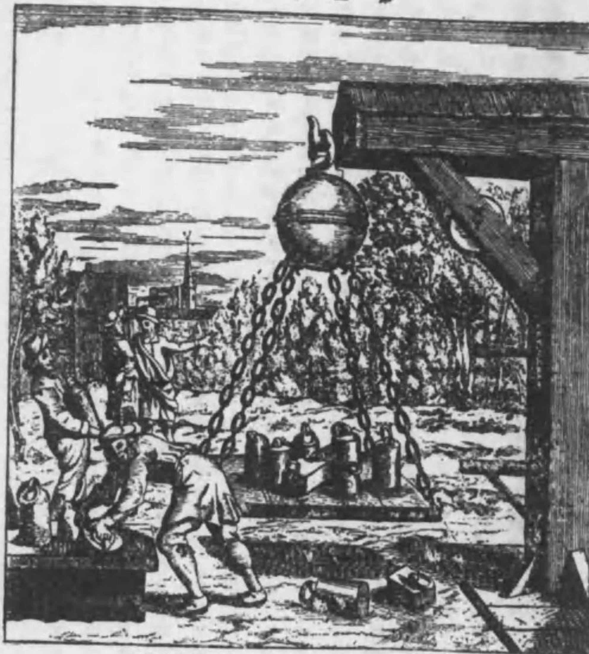
空気で同量気体のケリエグ)球半のグルブデグマ (す示なとこいなれ離に易容が球各の球たれるに
