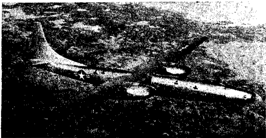
最新型四引擎轟炸機「XB-46」，係由噴氣機推動，全機僅載機員三人。
