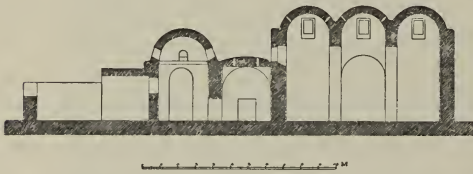
Fig. 104. Kusejir 'Amra. Längenschnitt.
