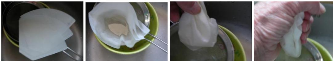
Le filtrage fonctionne très bien dans 3 filtres à café emboîtés. Verser en plusieurs fois la solution saline brute dans le filtre et presser doucement le filtre pour accélérer l'opération sans déchirer les filtres.
