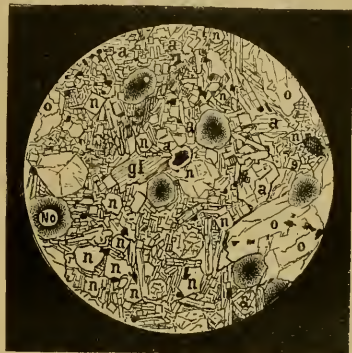
Fig. 3. Nephelinbasalt vom Mühlberg (Böhmen). (Vergrößerung 50fach.) n Nephelin, a Augit, o Olivin, m Magnetit, die schwarzen Partikel = Magneteisen.
