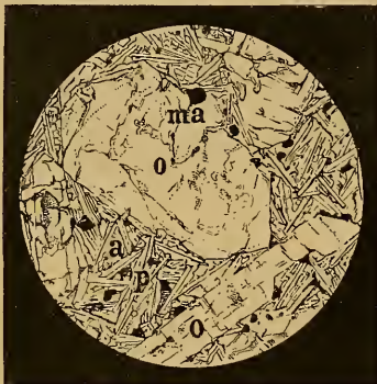
Fig. 5. Feldspatbasalt, künstlich dargestellt von Fouqué und Michel-Lévy. p Feldspat, a Augit, o Olivin, ma Magnetkies.
