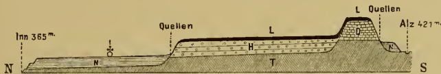
Durchschnitt durch die diluvialen Schotter zwischen Inn und Alz. T Tertiar. N jüngster Schotter. H mittlerer Schotter. L ältester Schotter. L 255. Horizontalsmaßstab 1 : 100 000. Vertikalsmaßstab 1 : 10 000.
