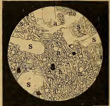
Fig. 1. Fluidalstruktur im Phenolith von Tschic, Cantal, Schicng durch kleine nadelartige Sanidinkristalle. (Vergroßderung 120fach.) a Sanidin, n Nephelin, n Nofean, a Augit, h Hornblende.
