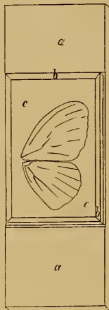
Objektträger a mit aufgetrockneten Hausenbläschen b, auf welchen ein Glasstück c ruht, so daß ein die Flügel schützende Zelle b c gebildet wird.
