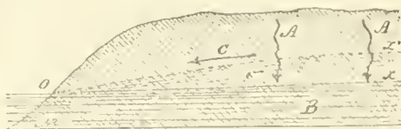
Fig. 114. — Écoulement d'une nappe souterraine.
