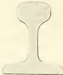
Fig. 86. — Coupe transversale d'un rail à patin.
